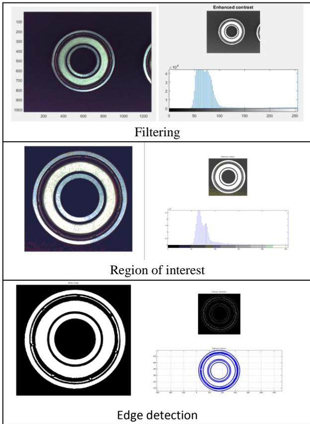
Fig. 9. Edge detection algorithm.
