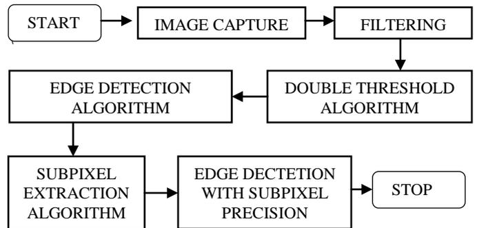
Fig. 7. Edge detection algorithm.
